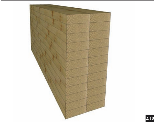
Fig. 2,9 Le bois massif contrecollé est obtenu par collage à plat de 2 ou plusieurs lames de bois massifs.
