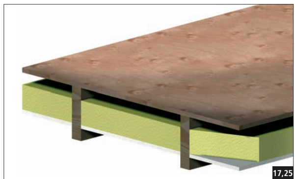
Fig. 17,26 Cette méthode permet de prendre des solives d'épaisseur inférieure à 60 mm pour une stabilité de 1/2 h.
